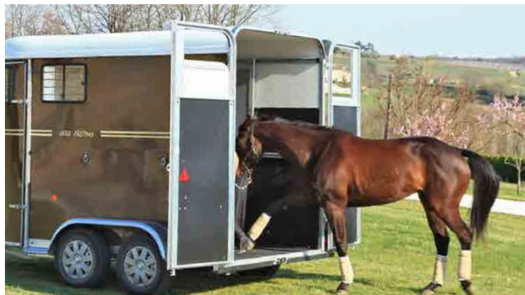
APERTURA FAUTRAS: 2 porte posteriori che canalizzano i cavalli per un facile imbarco. L'apertura senza rampa evita di doversi abbassare e offre la possibilità di arretrare davanti al box.
